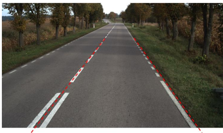
Rysunek 4: Reguły wyznaczania pasa ruchu w przypadku występowania oznakowania poziomego
